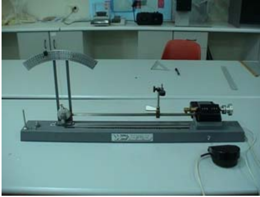
Şekil III.3. James H.Heal Büküm Ölçme Cihazı
