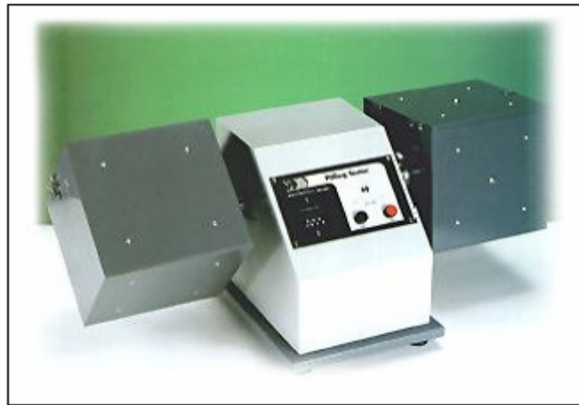
Şekil II.11. İki Kutulu İki Boncuklanma Test Cihazı [19]
