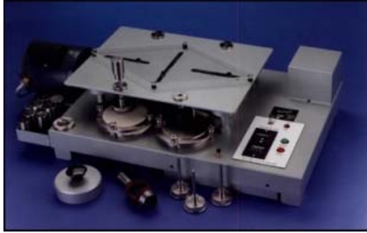
Şekil II.13. Martindale Aşındırma Cihazı[19]
