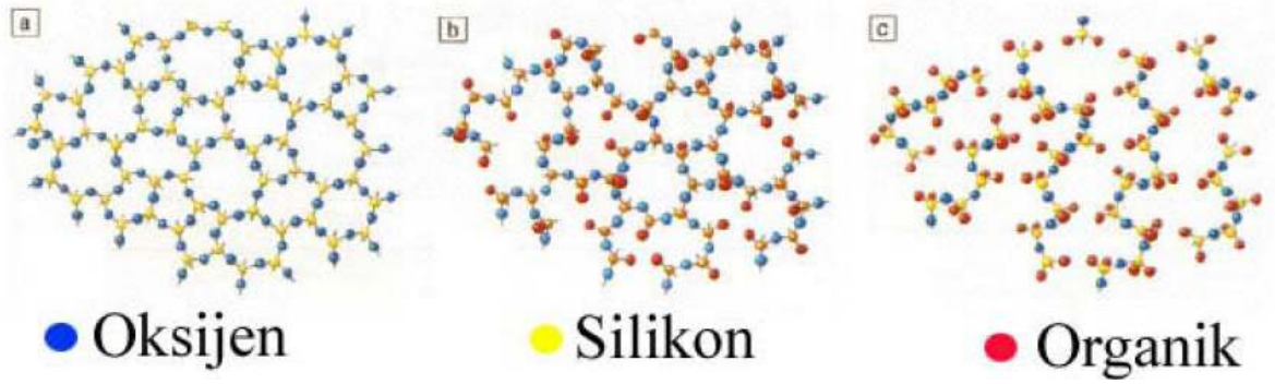
Şekil II.12. a) Her metal atomuna dört oksijen atomunun bağlandığı "Q" reçinesi yapısı, b) Her metal atomuna bir organik grubun bağlandığı, daha az rijit "T" reçinesi yapısı, c) Her metal atomuna iki organik grubun bağlandığı "D" reçinesi yapısı [50].
