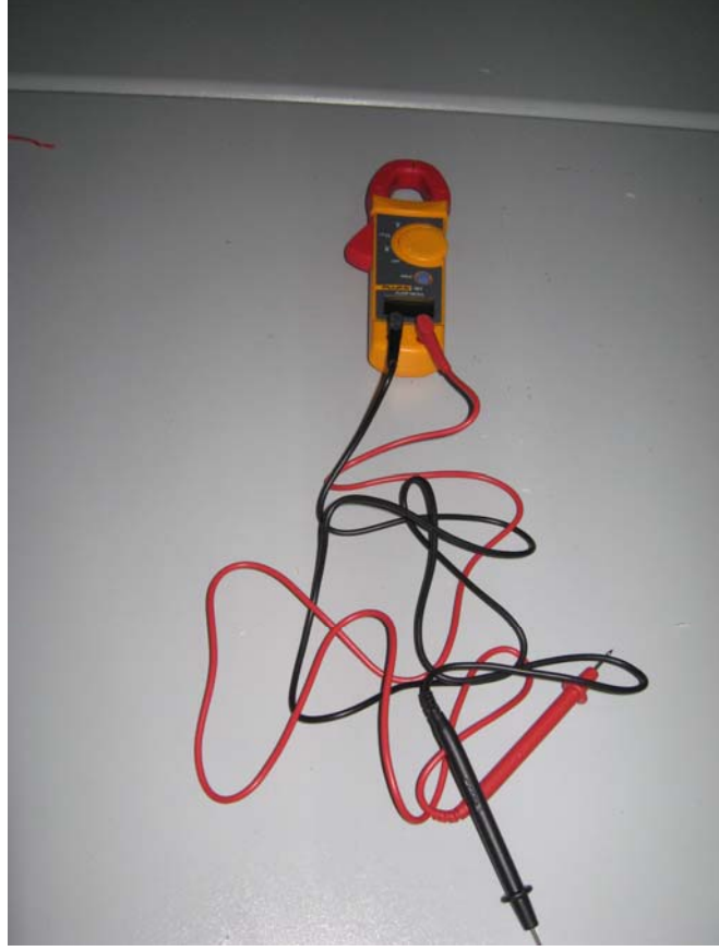
Şekil III.21 Devrenin Geçen Akım Miktarını Öğrenmek İçin Kullanılan Ampermetre
