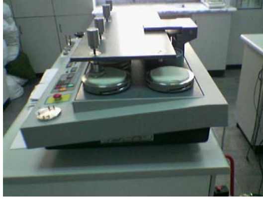
Şekil III.15 NU-Martindale Aşınma ve Boncuklanma Test Cihazı
