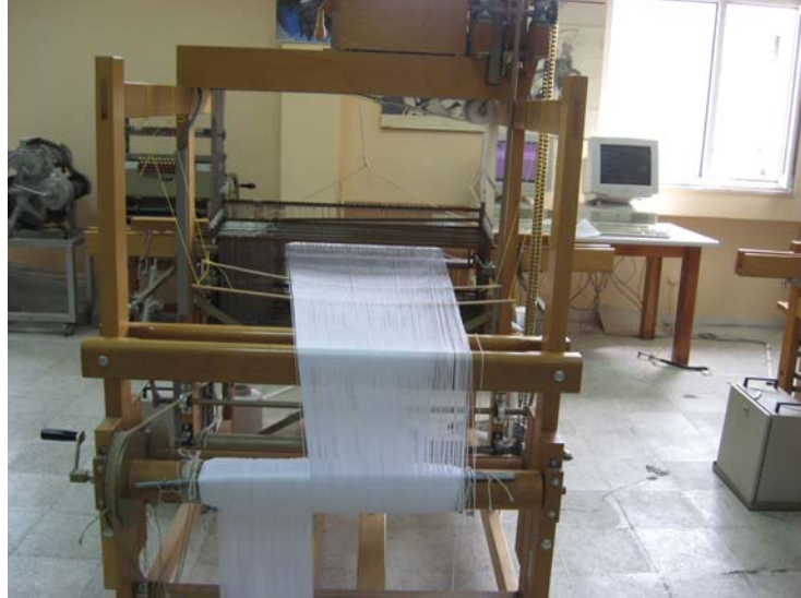
Şekil III.9 Dokuma İşleminin Yapıldığı Texy7 Marka El Dokuma Tezgâhı (Arka Görünüş)
