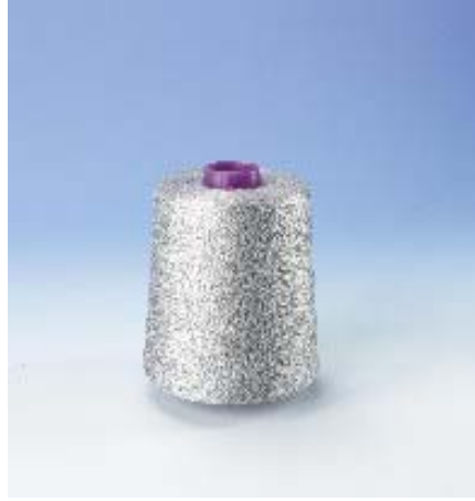
Şekil II.23 Nm 50-200 dtex % 20 Paslanmaz Çelik Liflerle Bükülmüş Polyester İplik
