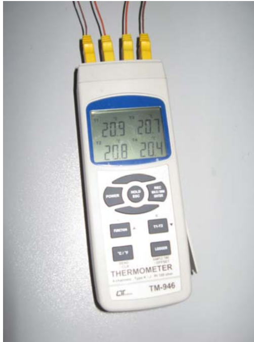
Şekil III.23 İpliklerin Ve Tellerin Derecesini Öğrenmek İçin Kullanılan 4 Kanallı Termometre
