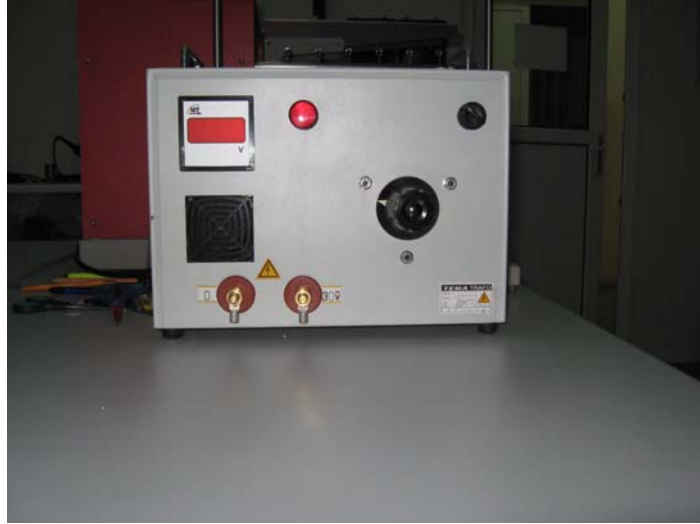
Şekil III.19 Paralel Devrede Güç Kaynağı Olarak Kullanılan Trafo
