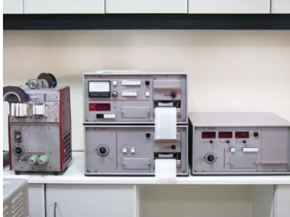
Şekil III.5 Düzgünsüzlük Ölçümlerinde Kullanılan Uster Tester I Cihazı
