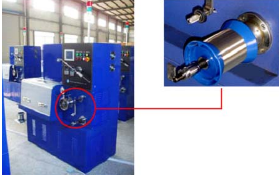
Şekil II.7. Paslanmaz Çelik Tel Çekme Makinesi-I
