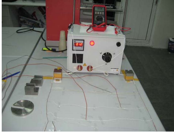
Şekil III.18 İpliklere Elektrik Enerjisinin Verildiği Paralel Bir Devre
