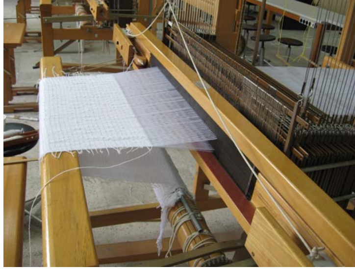
Şekil III.10 Dokuma İşleminin Yapıldığı Texy7 Marka El Dokuma Tezgâhı (Yan Görünüş)
