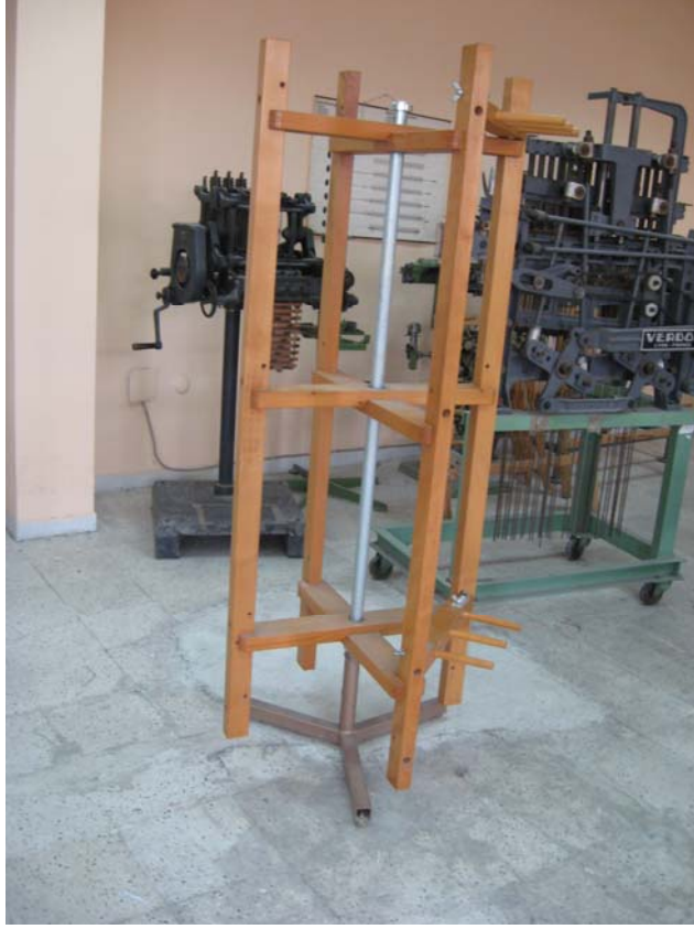
Şekil III.8 Dokuma İşlemi İçin Gerekli Olan Çözügünün Alındığı Makine
