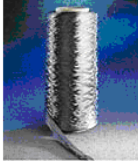
Şekil II.3 Demet Çekim Yöntemi ile Elde Edilen Metal Lif
