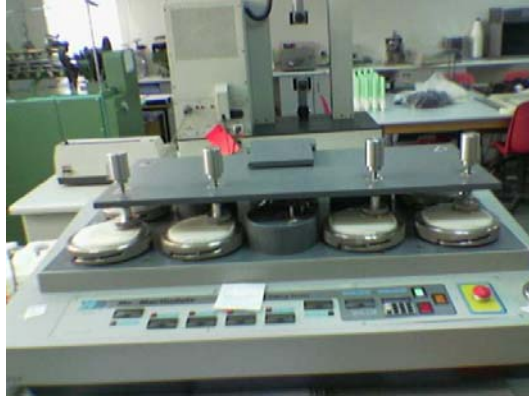
Şekil III.17 NU-Martindale Aşınma ve Boncuklanma Test Cihazı
