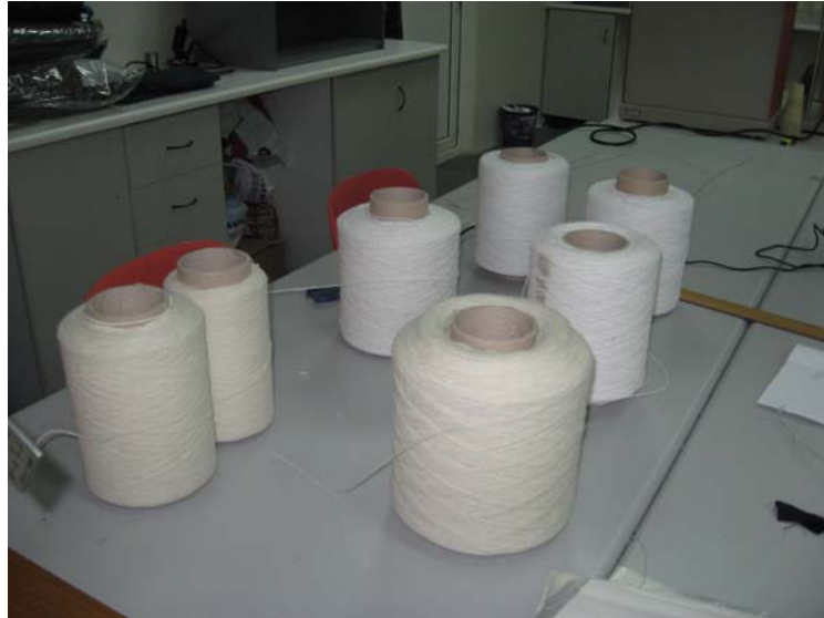
Şekil III.1 Dref 2000 Makinesinde Çekirdek İplik Yöntemiyle Elde Edilen İplikler
