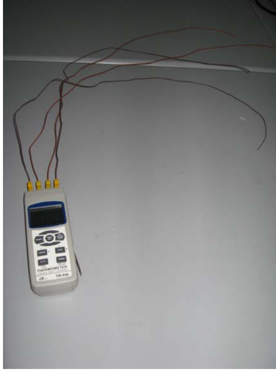
Şekil III.22 İpliklerin Ve Tellerin Derecesini Öğrenmek İçin Kullanılan 4 Kanallı Termometre
