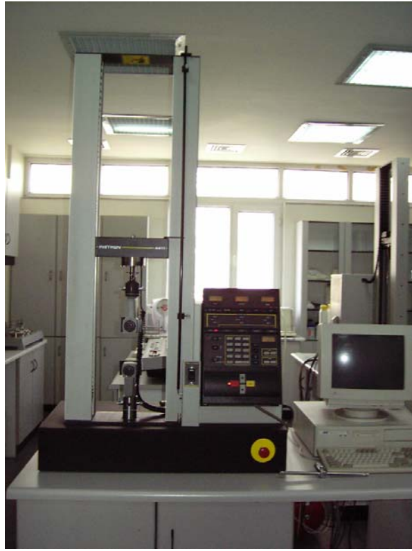
Şekil III.6 Instron Marka 4411 Model Mukavemet Ölçüm Cihazı
