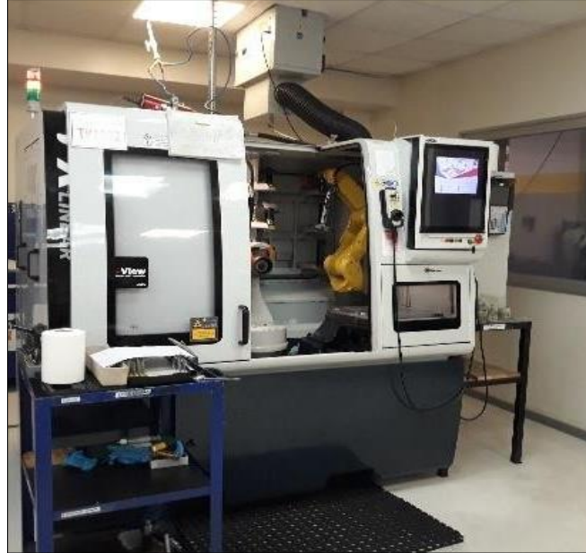
Şekil 2.12. ANCA FX-7 5 Eksen cnc takım bileme tezgâhı
