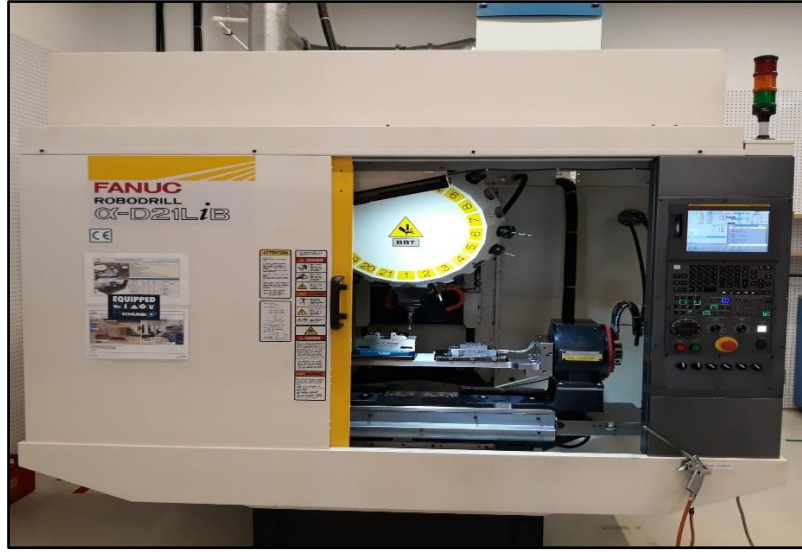
Şekil 2.25. Fanuc ROBODRILL alpha-21DLiB CNC dikey işleme merkezi
