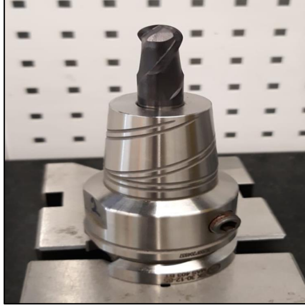
Şekil 2.26. Ø12 ballnose ve hidrolik tutucu
