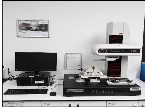
Şekil 2.31. Yüzey pürüzlülük ve form ölçüm cihazı
