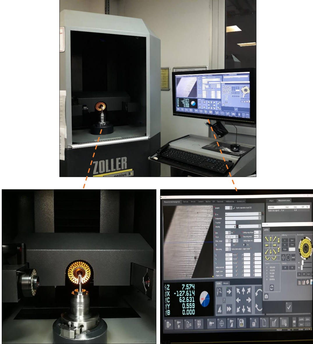
Şekil 2.16. Zoller Genius takım ölçüm cihazı
