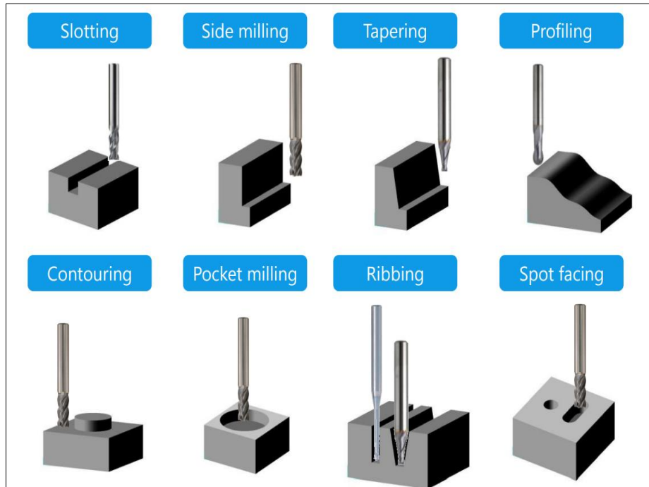
Şekil 1.2. Frezelemede kullanılan operasyonlar
