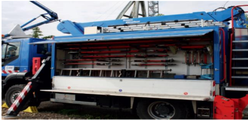
Şekil 2.4. Canlı çalışmada kullanılan aletlerin kamyon üzerinde gösterimi [18]
