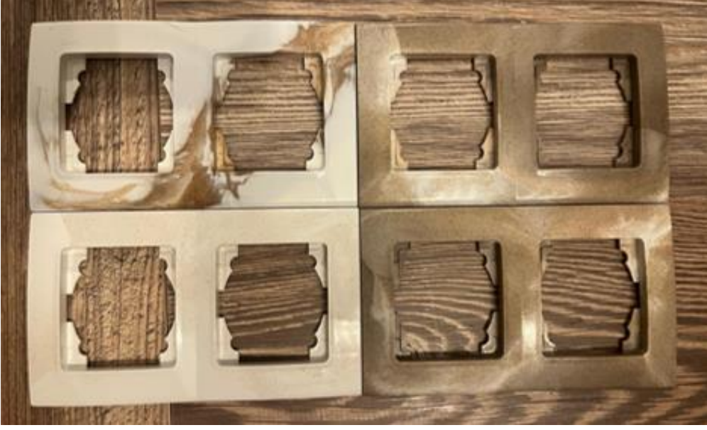
Şekil 4. 1 ABS+ %3 Kenevir karışımının çerçeve üretiminde uygulanması
