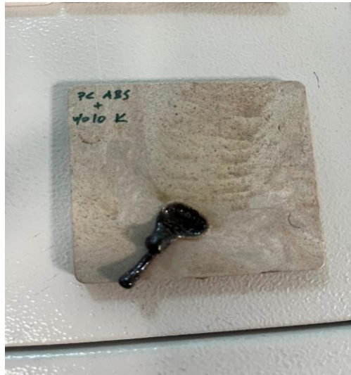
Şekil 3. 20 Kızgın tel deneyine maruz kalmış PC/ABS+%7 fındık kabuğu
