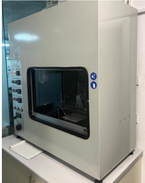
Şekil 2. 19 ZLT-GTR kızaran tel test cihazı
