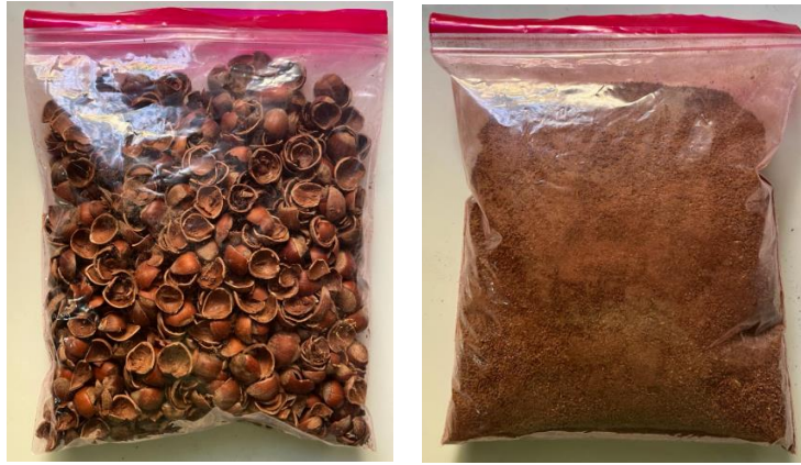
Şekil 2. 2 Fındık kabuğu ve öğütülmüş formu
