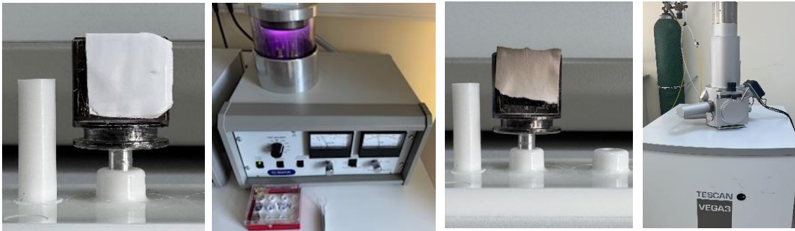
Şekil 20 Membran örneğinin Au/Pd kaplamasının yapılması
