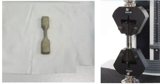
Şekil 21 Mekanik test için numunenin hazırlanması ve ölçümünün yapılması
