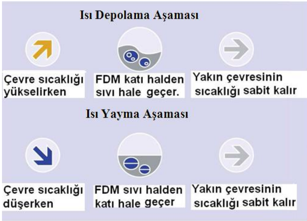
Şekil 2.3. Faz değişim malzemelerinin ısıyı depolama ve yayma çevrimi.
