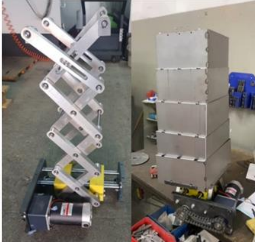
Şekil 3.4 Çöp kutusunun iç mekanizması.
