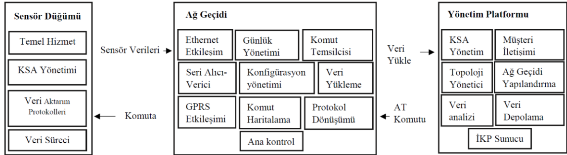
Şekil 2.11: IoT Ağ Geçidi sisteminin yazılım mimarisi.
