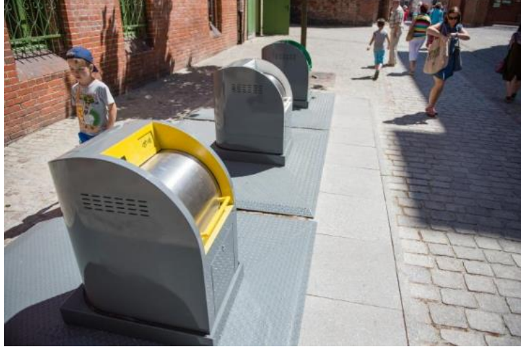
Şekil 2.2 Yeraltı atık depolama sistemi.
