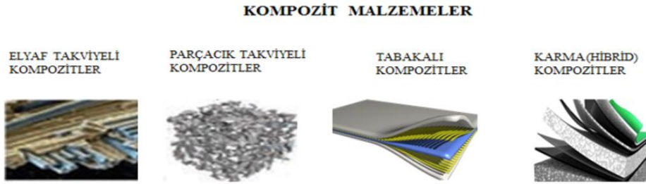
Şekil 1.5 Dolgu türlerine göre kompozit malzemeler [20]
