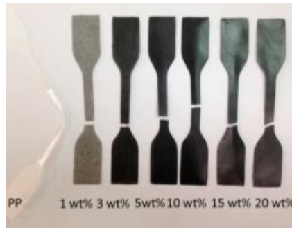
Şekil 1.8 Chien-Lin Huang ve arkadaşlarına ait çalışmadaki teste kullanılan çekme numuneleri [22]
