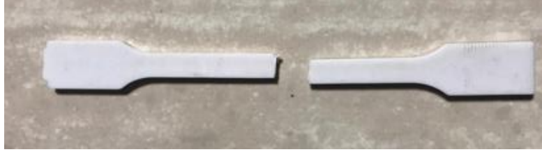
Şekil 3.1 Kırılan Test Numunesi Örneği
