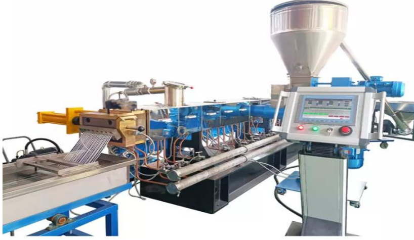
Şekil 2.2 Çift Vidalı Ekstrüzyon Hattı
