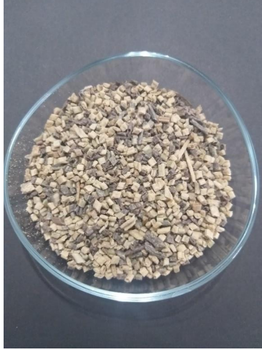
Şekil 2.13 Ağırlıkça %30 Sarıçam Dolgulu Geri Dönüşüm PP Granül
