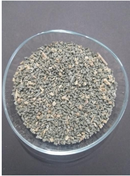
Şekil 2.11 Ağırlıkça %10 Sarıçam Dolgulu Geri Dönüşüm PP Granül
