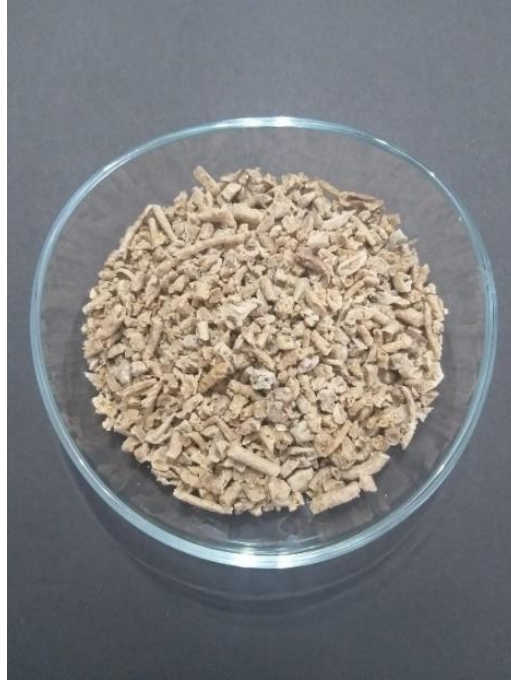
Şekil 2.14 Ağırlıkça %40 Sarıçam Dolgulu Geri Dönüşüm PP Granül
