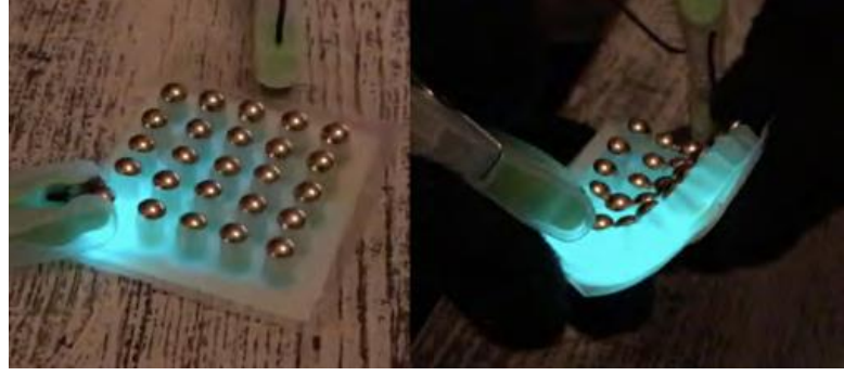
Şekil 19: Birden fazla şişkin temas noktasına sahip elektrominesans örnek.
