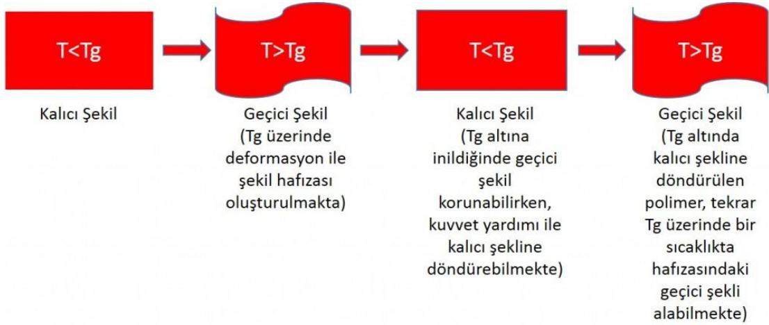
Şekil 10: Camsı geçiş sıcaklığındaki değişimine göre şekil değişimi
