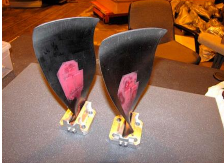
Şekil 8. Piezoelektrik fan kanadı testi
