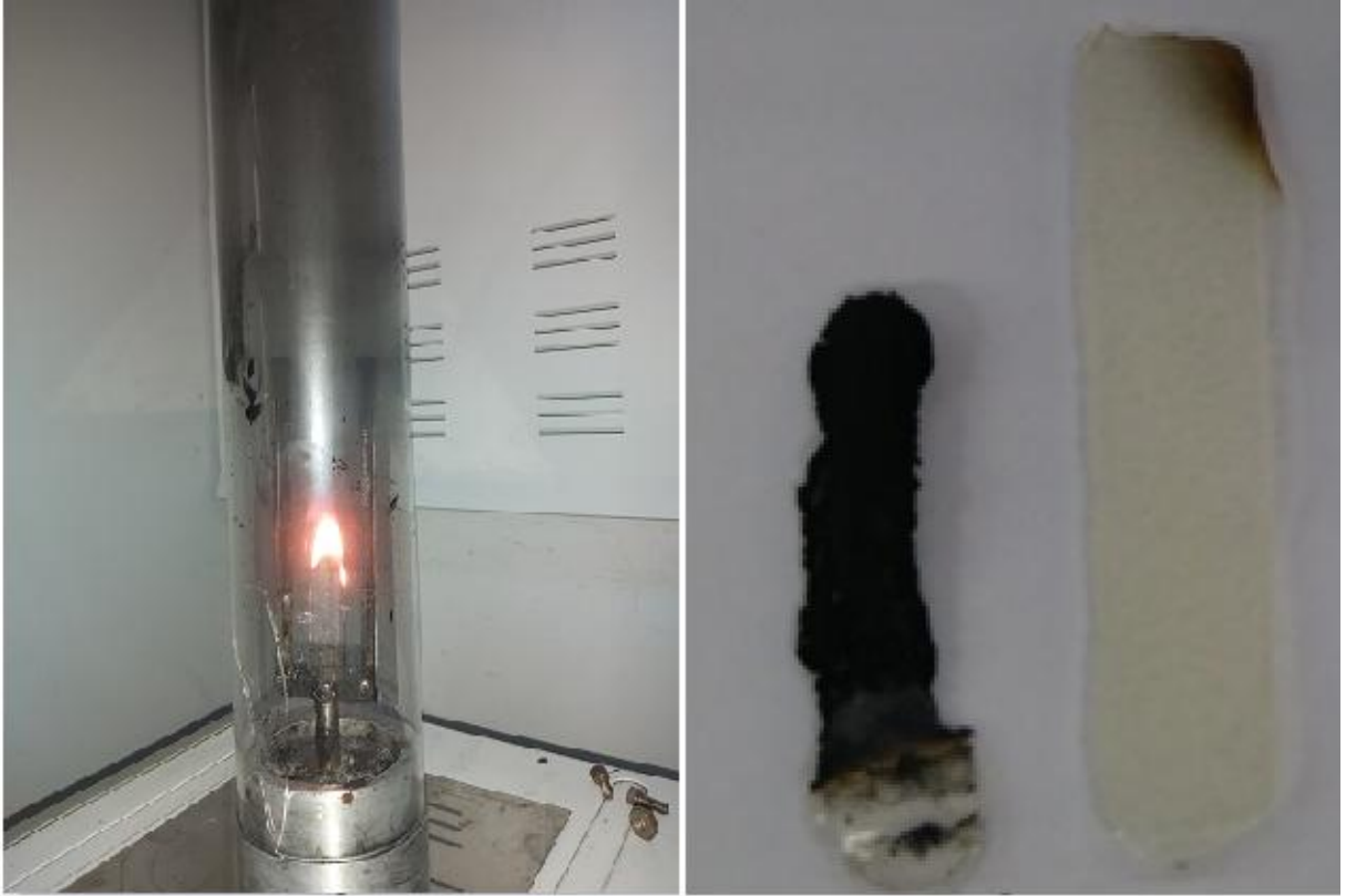
Şekil 3.11.: LOI Testi ve 24% oksijen değerinde boş ve %10MPSsPUR
