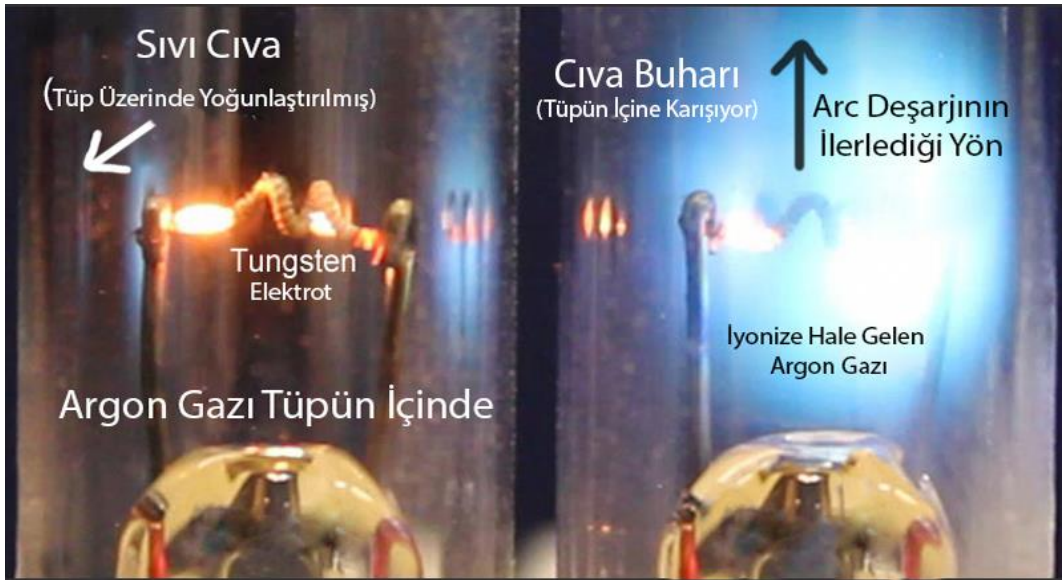
Şekil 9: Isınan Tungsten Elektrot, İyonize Hale Gelen Gaz ve Buharlaşan Cıva
