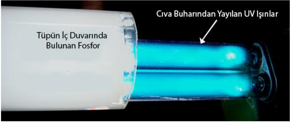
Şekil 10: Tüpün İç Duvarında Bulunan Fosfor ve UV Işınlar
