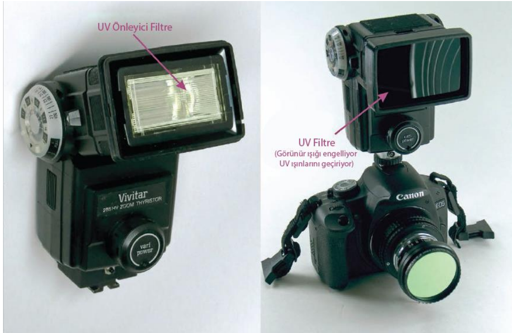
Şekil 13: Flaşın UV Filtre Takılarak Modifiye Edilmesi
