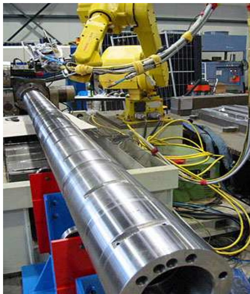
Şekil II.28. Hava Sanayinde Kullanılmak üzere Lazerle Yüzeyleri Sertleştirilmiş Mil
