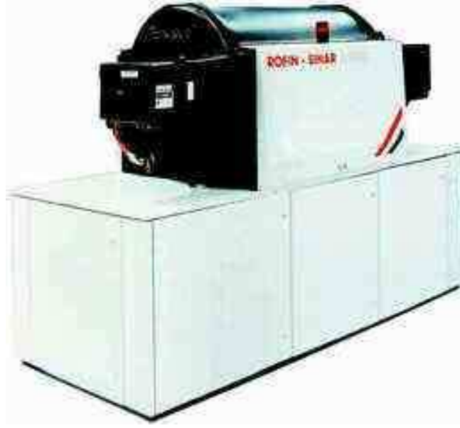
Şekil II.11 Rofin Sinar HF Uyarımlı Çapraz Akışlı CO 2 Lazer
