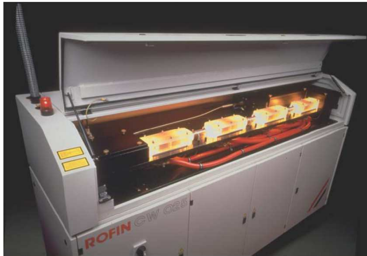
Şekil II.15 4 Tane Odalı Rofin Sinar 2.8 kW Nd:YAG Lazer
