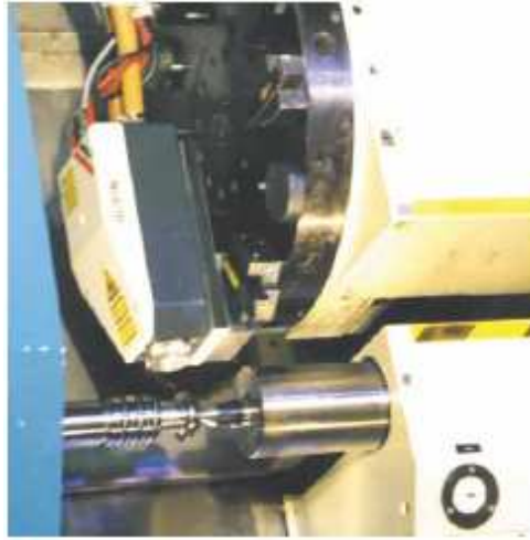
Şekil II.27. Lazer Serleştirme Aletinin CNC Torna Tezgahına Entegrəsi
