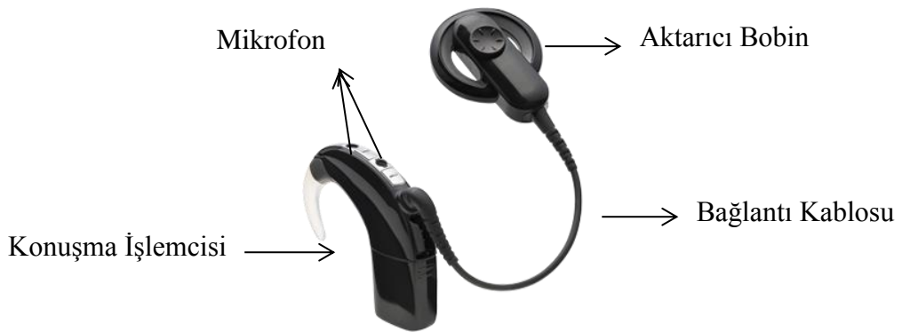
Şekil 1: Koklear implantın dış parçaları
