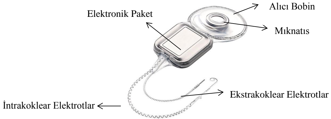
Şekil 2: Koklear implantın iç parçaları
