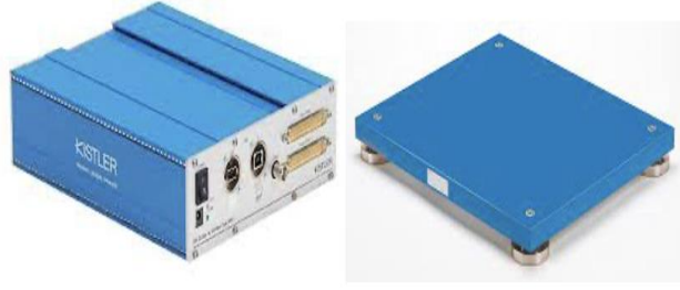
Şekil 44. Kistler marka kuvvet platformu
