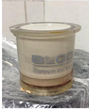
Resim 5.4. Hazırlanan modellerin revetmana alınması
