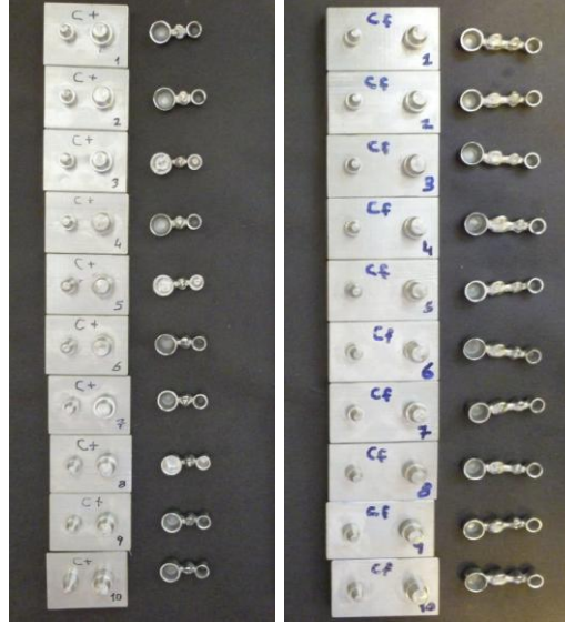
Resim 5.14. CAD/CAM metal frezeleme yöntemiyle üretilmiş metal altyapılar
