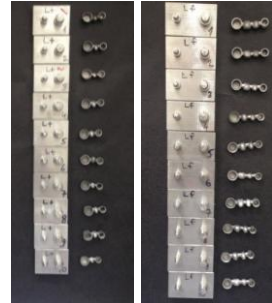
Resim 5.18. Lazer sinterleme yöntemiyle üretilmiş metal altyapılar
