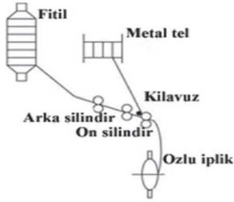
Şekil 1.3 Özlü İplik Metoduyla İletken İplik Elde Edilmesi [2]
