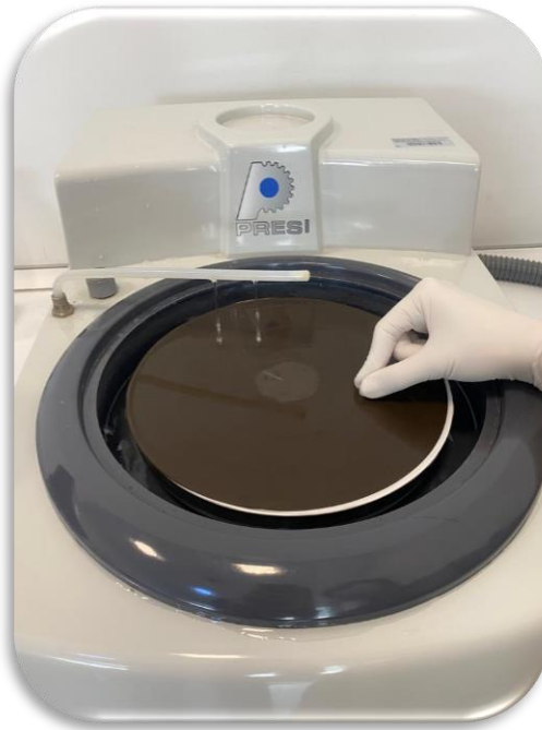
Őekil 5.5. rneklere zımparalama iŐleminin uygulanması
