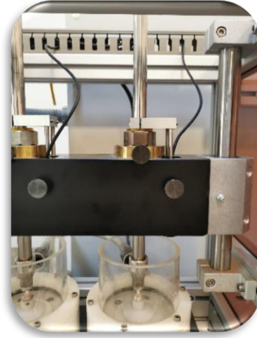
Şekil 5.38. Çiğneme simülatörünün üst ve alt kompartımanları ve sıvı haznesi
