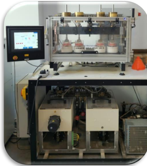
Şekil 5.37. Dual akslı çiğneme simülatörü
