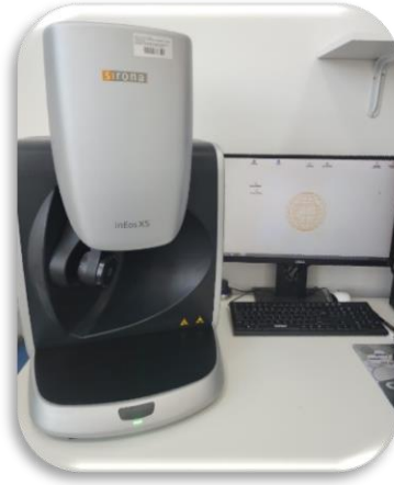
Şekil 5.34. in Eos X5 tarama cihazı
