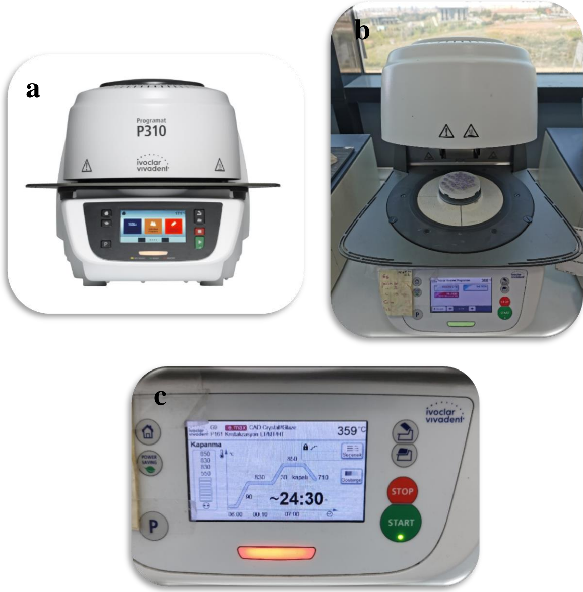
Şekil 5.6. IPS e.max CAD örneklerin kristalize edilmesi a. Programat P310 seramik fırını b. Seramik fırınına yerleştirilen örnekler c. IPS e.max CAD kristalizasyon programı
