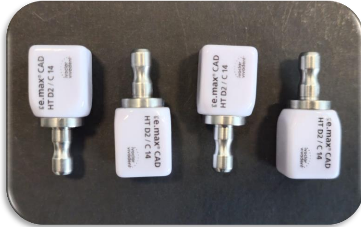
Şekil 5.1. IPS e.max CAD ingotlar
