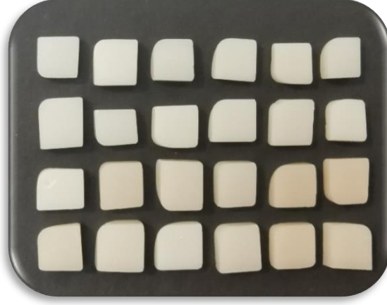
Şekil 5.7. Kristalize edilmiş IPS e.max CAD örnekler
