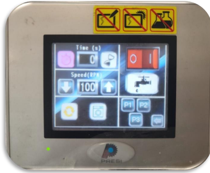
Őekil 5.4. Zımparalama parlatma cihazının dokunmatik LCD ekranı
