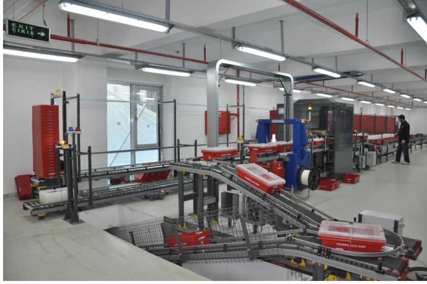
Şekil 3. İstanbul Ecza Kooperatifi İlaç Paketleme Sistemi- Otomasyon Sistemi
