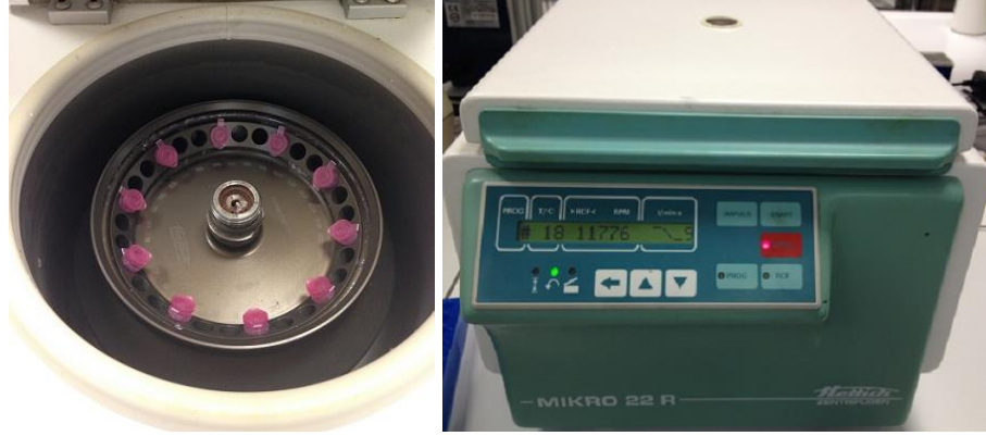
Resim 21. Toplama tüplerinin santrifüj cihazına yerleştirilerek santrifüj edilmesi
