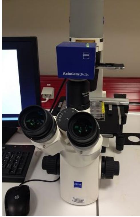
Resim 18. ALR boyama yöntemi ile hazırlanan örneklerden invert mikroskop altında görüntü alınması
