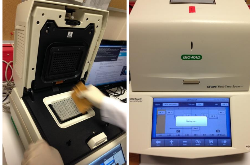
Resim 25. Reaksiyon plağının Gerçek Zamanlı PZR cihazına yerleştirilerek okutulması
