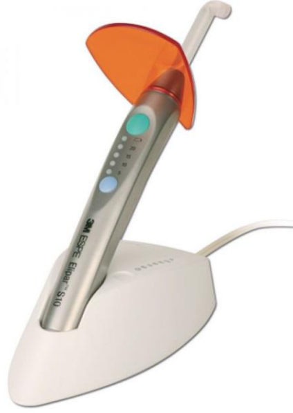
Resim 4. Kompozit örneklerinin polimerizasyonunda kullanılan ışık cihazı (Elipar S10, 3M ESPE Dental Products; Minnesota, Amerika)
