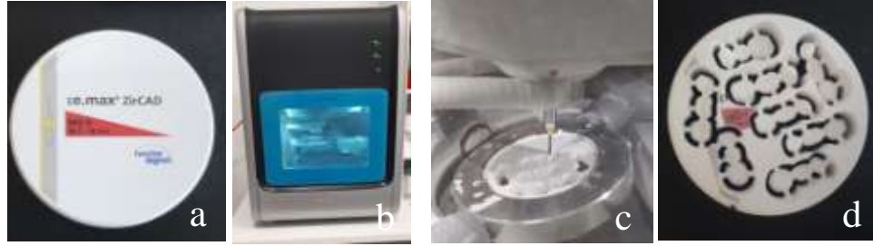
Resim 5.7. Üretim aşaması ( a. Presinterize yitriyum stabilize zirkonyum dioksit disk; b. Inlab MC X5; c. Frezeleme işlemi; d. Üretilen altyapılar).
