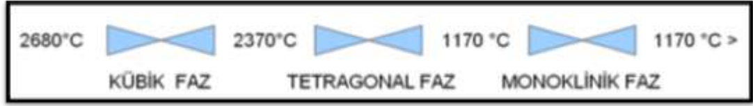
Şekil 4.1. Zirkonyumun kristal fazları ve dönüşüm sıcaklıkları.
