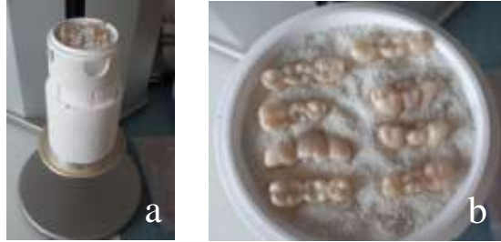
Resim 5.14. Sinterizasyon aşaması (a. Sinter cihazı; b. Sinterizasyon sonrası restorasyonlar).
