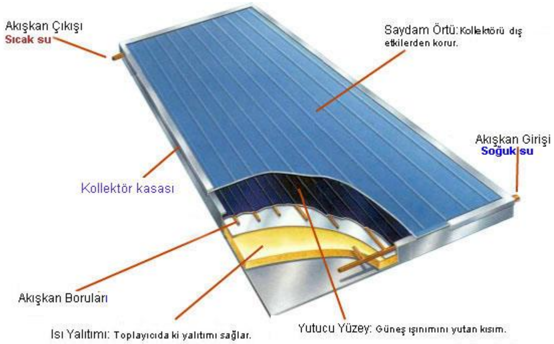
Şekil 2. 5 Düzlemsel Güneş Kolektörlerinin Yapısı
