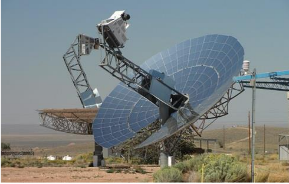
Şekil 2. 7 İki eksenli olarak güneşi takip eden, güneş enerjisinden elektrik üretimi sistemi
