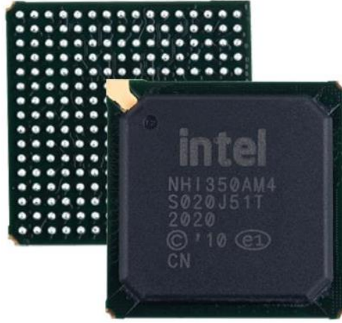
Şekil 2.2. Intel Ethernet PHY Entegresi [33]
