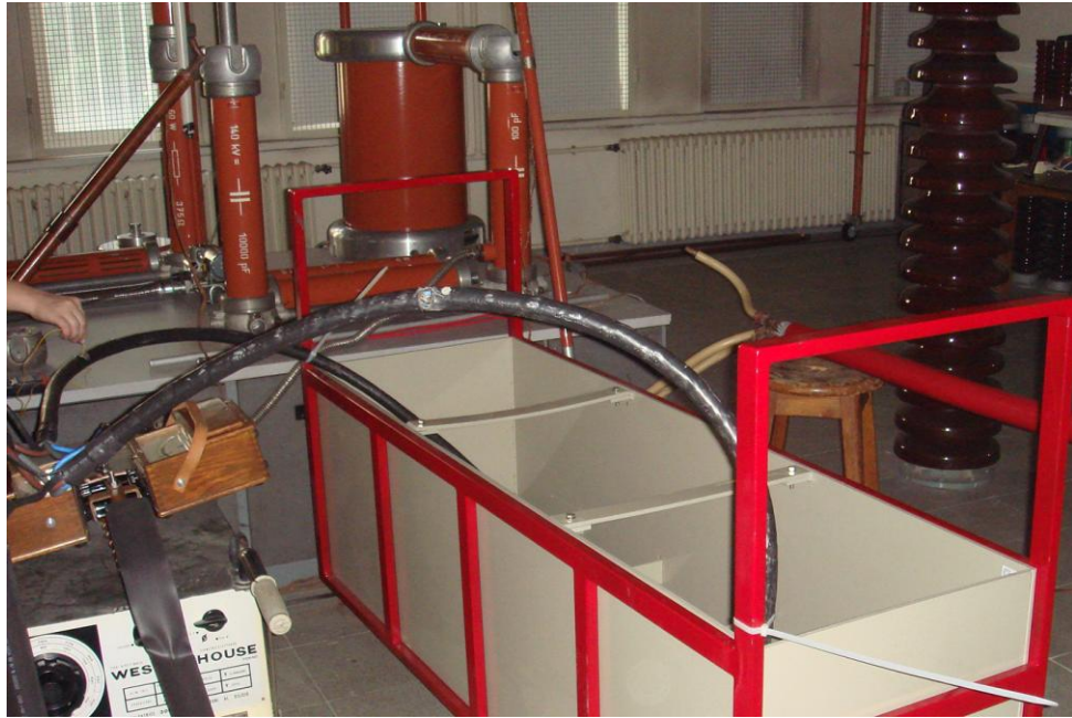
Şekil V.23 0.6/1kV kablo için kurulan deney düzeneği
