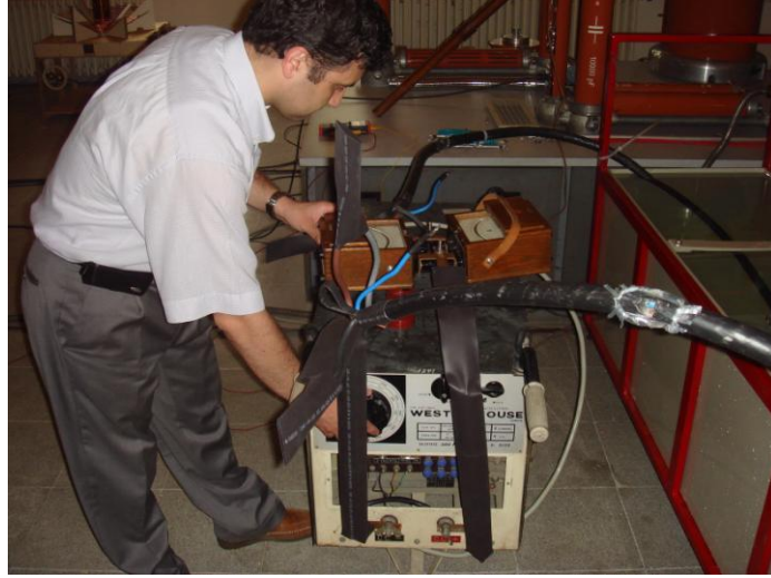
Şekil B.3 Çıkış akımının varyak yardımı ile ayarlanması
