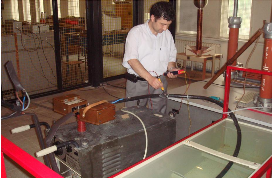
Şekil V.25 0.6/1kV kablo için kurulan deney düzeneği
