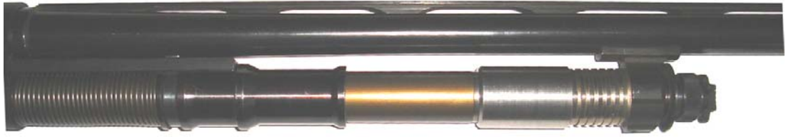
Şekil. D2. Fabar Marka Gaz Otomatik Tüfeğin Tahliye Sistemi (Açık Pozisyon)
