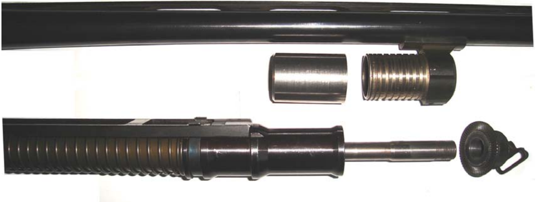
Şekil. D3. Fabar Marka Gaz Otomatik Tüfeğin Tahliye Sistemi (Demonte Görünüm)
