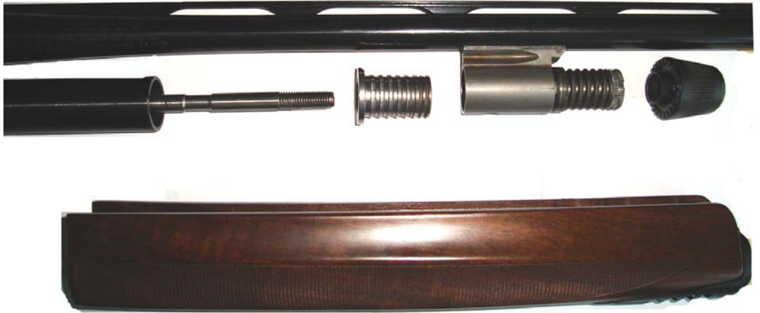
Şekil. D3. Baretta Marka Gaz Otomatik Tüfeğin Tahliye Sistemi (Demonte Görünüm)
