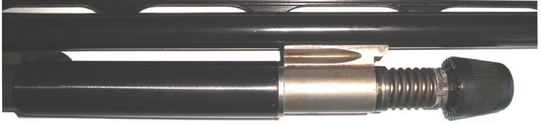
Şekil. D4. Baretta Marka Gaz Otomatik Tüfeğin Tahliye Sistemi (Kapalı Pozisyon)
