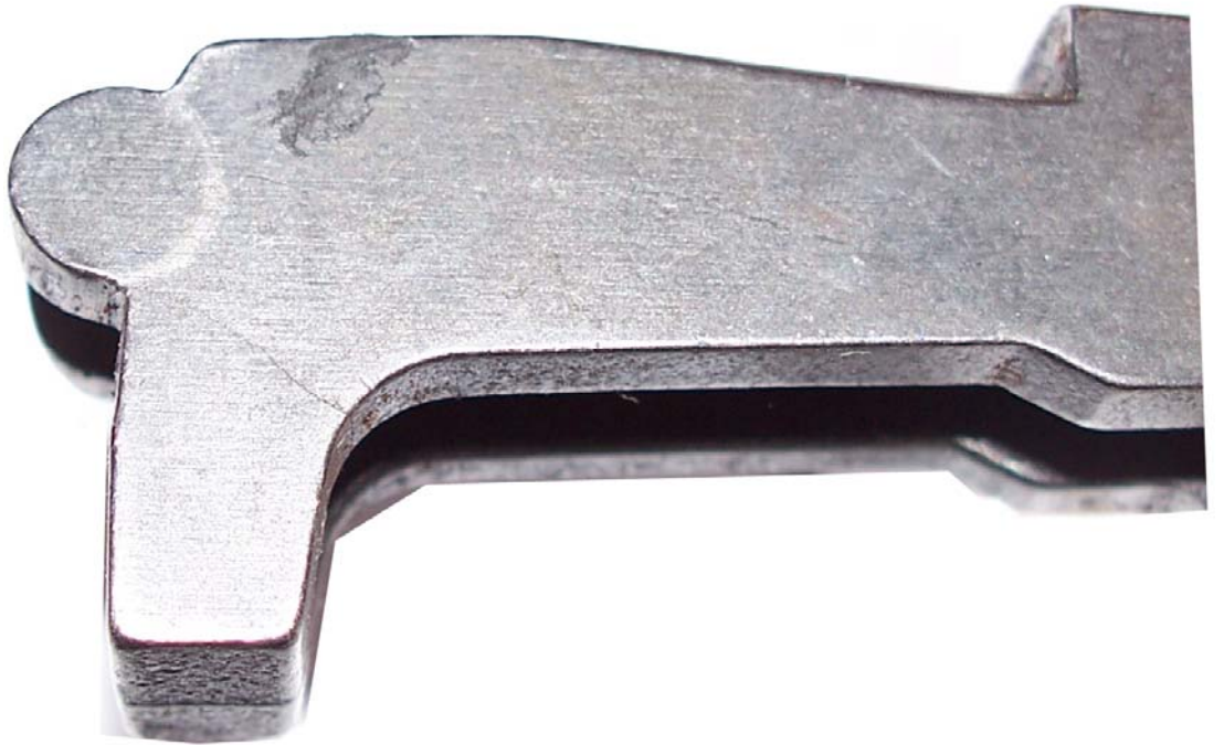
Şekil. B2. Çatlak Oluşumu ve Çatlağın İlerleyişi
