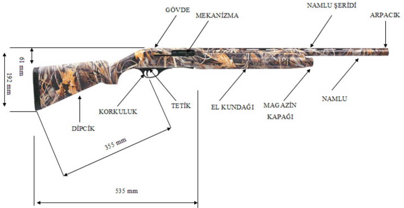
Şekil II.13. Gaz Otomatik Av Tüfeğini Oluşturan Ana Parçalar
