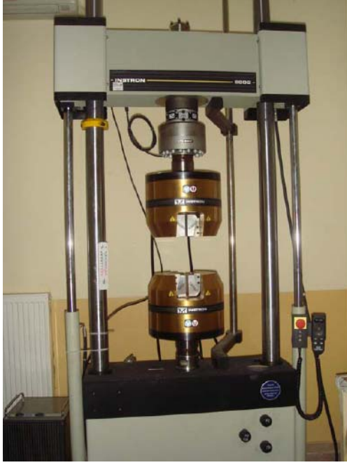
Şekil 12) Ölçümlerin yapıldığı Instron cihazı (Model 8802)
