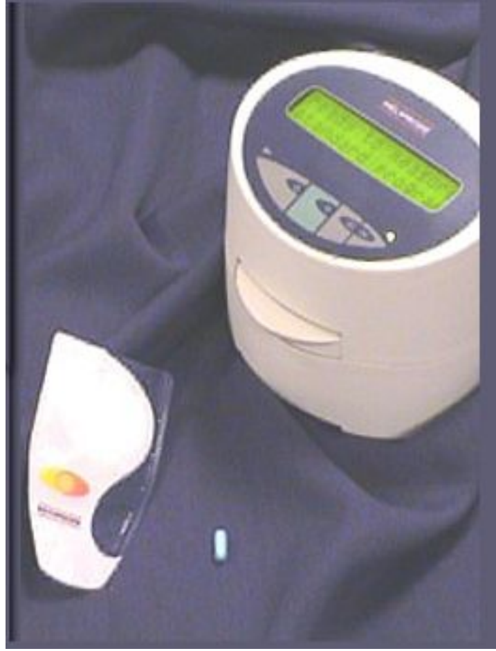
Resim 3. HELIPROBE™ ÜNT Sistemi (Beta sayıcı, test kapsülü ve soluma kartuşu).
