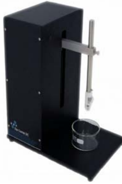
Şekil III.4 Daldırarak ince film kaplama deney düzeneği
