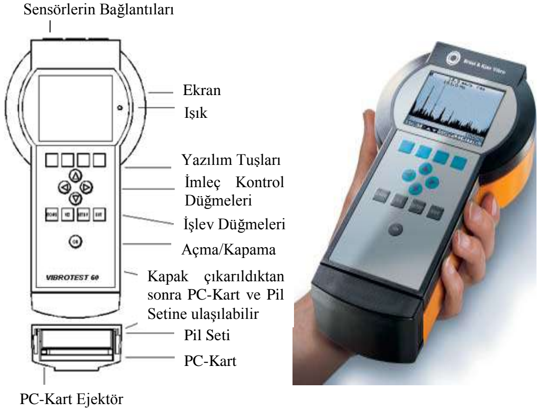
Şekil III. 12 Schenck VibroTest60 Cihazı
