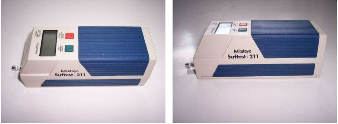
Şekil III. 14 Mitutoyo SurfTest S211 Yüzey Pürüzlülüğü Ölçüm Aleti
