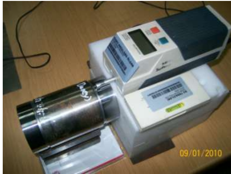
Şekil III. 15 Yüzey Pürüzlülüğü Ölçümlerinin Yapılması
