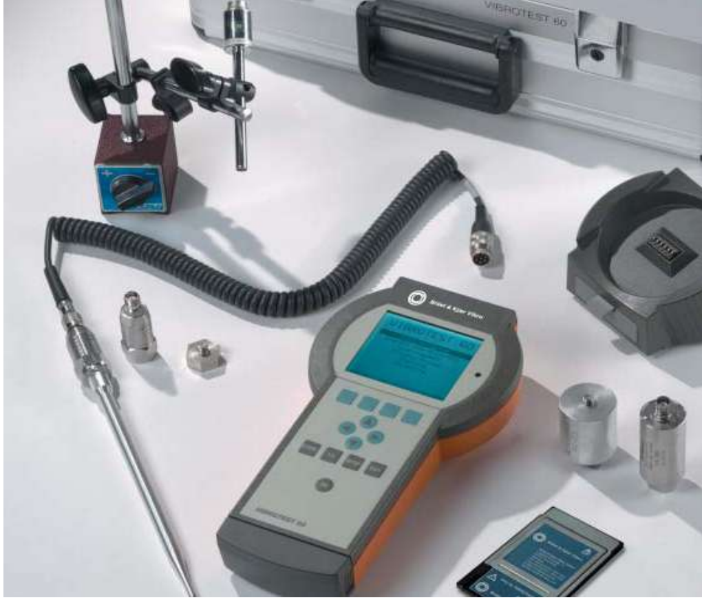
Şekil III. 11 Schenck VibroTest60, El Tipi Çift Kanallı Titreşim Ölçüm, Analiz Cihazı ve Ekipmanları
