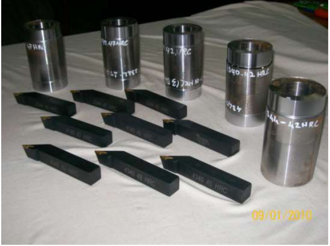
Şekil III. 19 Deneyde Kullanılan Takım Tutucular ve İşlenmiş Parçalar
